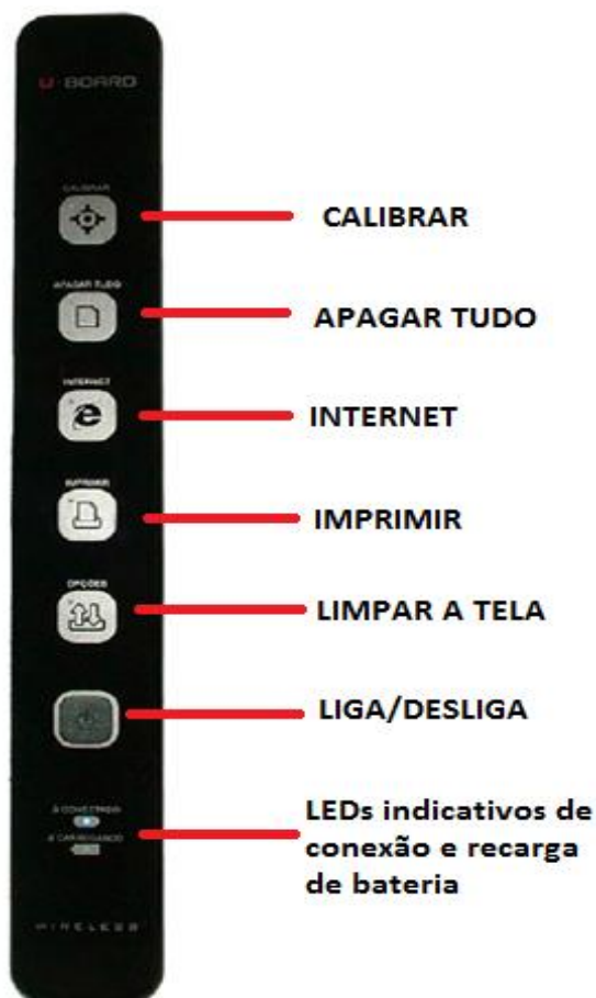
Figura 10 - Receptor Station . Fonte: Autoria própria.
