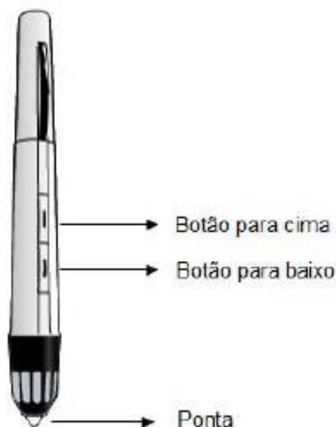
Figura 11- Caneta utilizada na lousa digital interativa uBoard. Fonte: Digibras (2014, p. 4).
