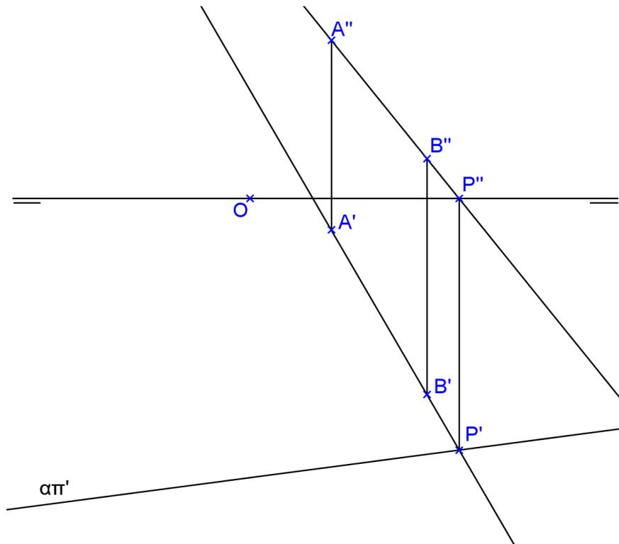
3. Represente as projeções do prisma quadrangular regular de base ABCD contida no plano qualquer definido pelos pontos A, B e pelo traço  $\alpha\pi'$ , sabendo-se que a altura mede  $h=45$ . Representar a seção plana neste prisma feita por um plano de topo que passa pela origem e forma  $45^\circ$  com  $\pi'$ .
