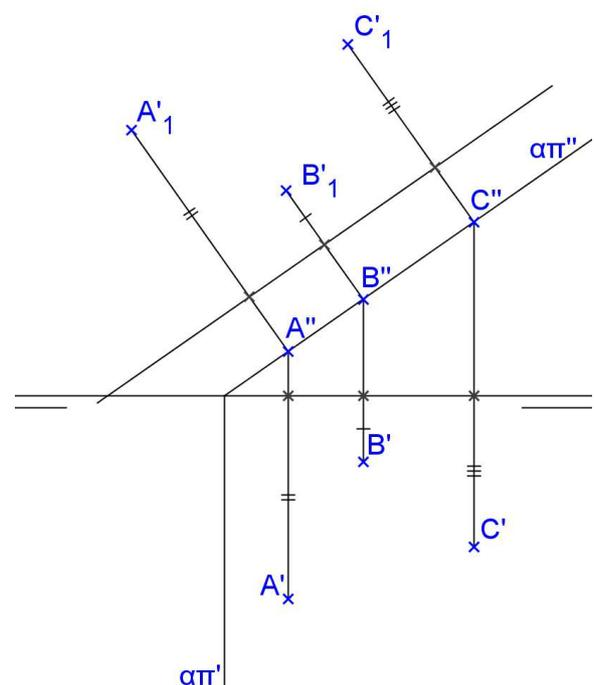
12. Representar um hexaedro regular de aresta AB com uma face sobre o plano de topo  $\alpha$  que contém P(10,00,00) e forma  $45^\circ$  com  $\pi'$ . Dados A(-30,40,?), B(-10,20,?). Representar a seção plana feita neste sólido por um plano de topo que passa por R(60,00,00) e forma  $30^\circ$  com  $\pi'$ .
