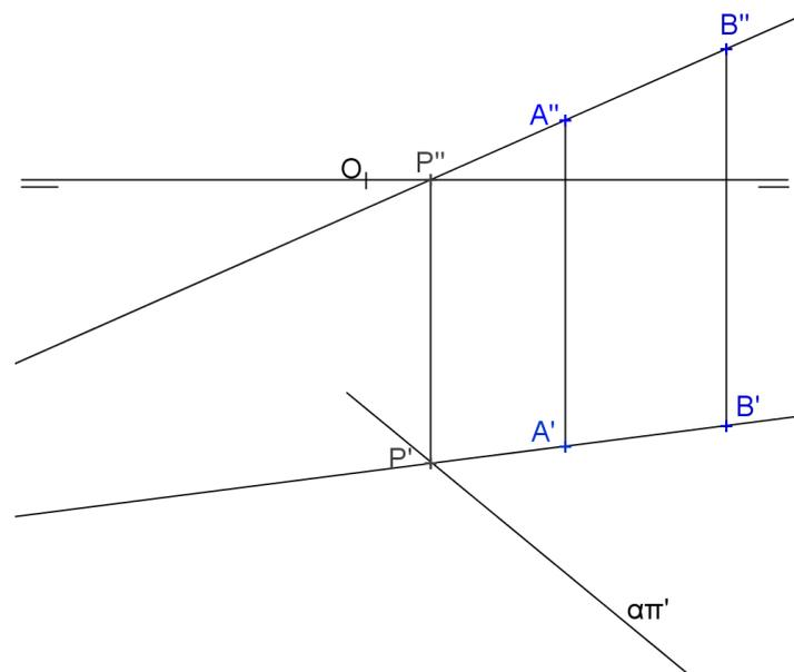
5. Represente as projeções do octaedro regular de aresta AB, com a seção equatorial ABCD contida no plano qualquer  $\alpha(A,B,P)$ . Dados:  $A(40,40,20)$ ,  $B(60,15,35)$  e  $P(30,05,50)$ .
