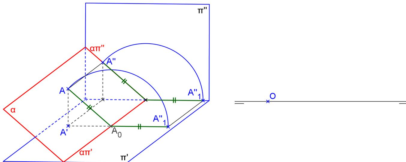
Rebatimento sobre um plano horizontal: basta considerar um plano  $\beta$  horizontal e usar  $(\alpha\beta)$  como eixo do rebatimento, ou seja, utilizar  $(\alpha\beta)'$  como se fosse  $\alpha\pi'$ .
