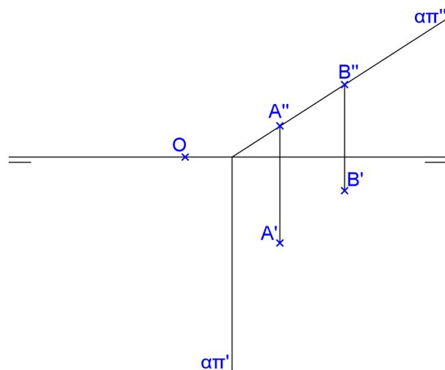
4. Representar uma pirâmide regular quadrangular V-ABCD com a base apoiada em um plano  $\alpha$  de topo que passa pela origem e forma  $45^\circ$  com  $\pi'$ , dados A(10,20,?) e B(30,00,?), h=50.
