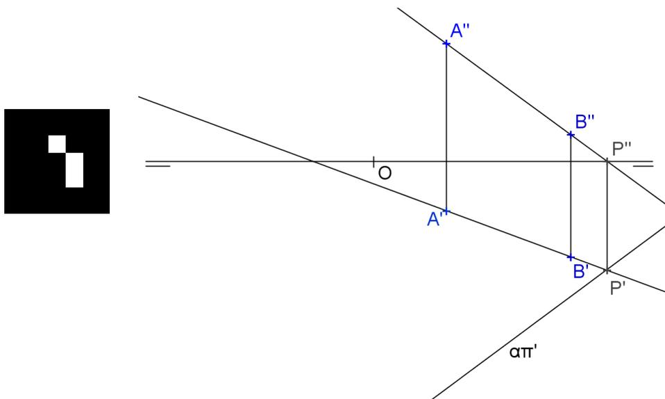
4. Representar as projeções da pirâmide regular hexagonal com a base ABCDEF contida no plano qualquer definido pelos pontos A, B e pelo traço  $\alpha\pi'$ . A altura da pirâmide mede  $h=50$ .
