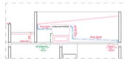
DETALHE CISTERNA ESCALA 1:50
