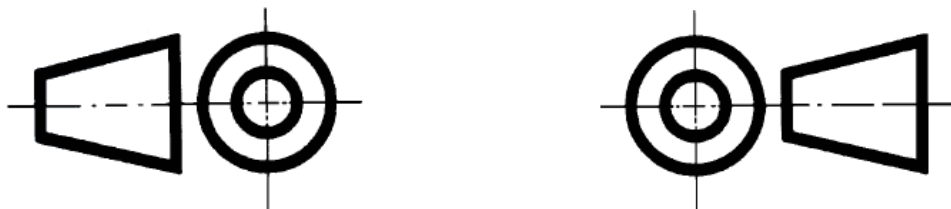
Figura 01 - Símbolos do método de projeção ortogonal no 1º diedro e no 3º diedro
