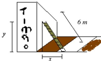
**Exemplo 6:** A que taxa o nível do líquido diminui dentro de um tanque cilíndrico vertical se bombeamos o líquido para fora a uma taxa de 3000L/min? (raio  $r$  do cilindro igual a 1m).
