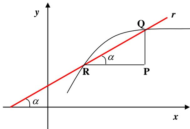
Coeficiente angular de  $r$  (inclinação da reta  $r$ ) =  $\operatorname{tg} \alpha = \frac{PQ}{RP}$
