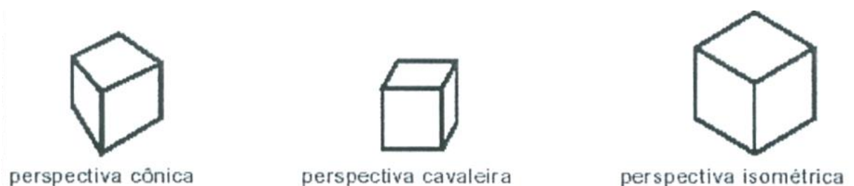
Figura 47 – Representação de um cubo em três tipos de perspectiva
