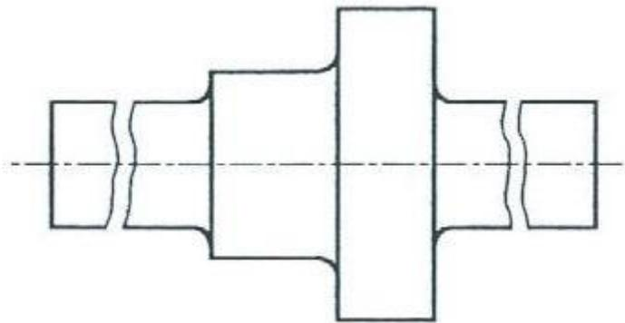
Figura 67 – Vistas interrompidas de peças compridas
