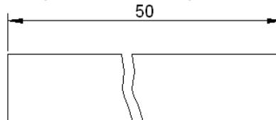
Figura 20 – Cotagem em elemento interrompido
