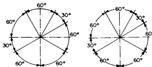
Figura 30 – Cotagem angular no método 2
