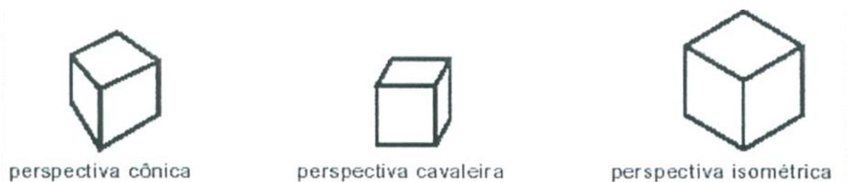
Figura 47 – Representação de um cubo em três tipos de perspectiva
