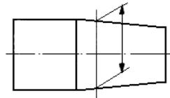
Figura 19 – Linha auxiliar oblíqua ao elemento dimensionado
