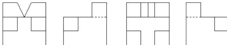
3) Identifique a Vista de Frente, a Vista Superior, a Vista Lateral Esquerda e a Vista Lateral Direita nas projeções dadas.
