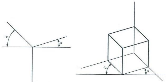
Figura 49 – Perspectiva trimétrica de um cubo
