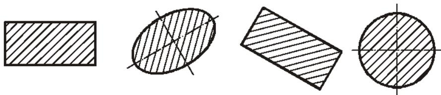
Figura 80 – Exemplos de hachuras para qualquer material
