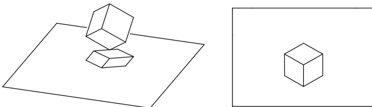
Figura 55 – Perspectiva isométrica de um cubo
