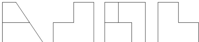
4) Identifique a Vista de Frente, a Vista Superior, a Vista Lateral Esquerda e a Vista Lateral Direita nas projeções dadas.
