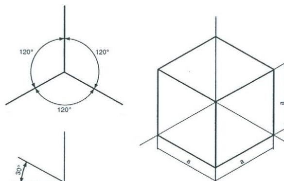
Figura 51 - Perspectiva isométrica de um cubo
