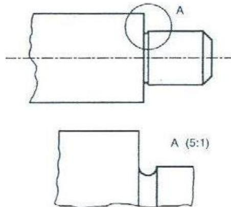
Figura 69 – Vista de detalhe de uma peça
