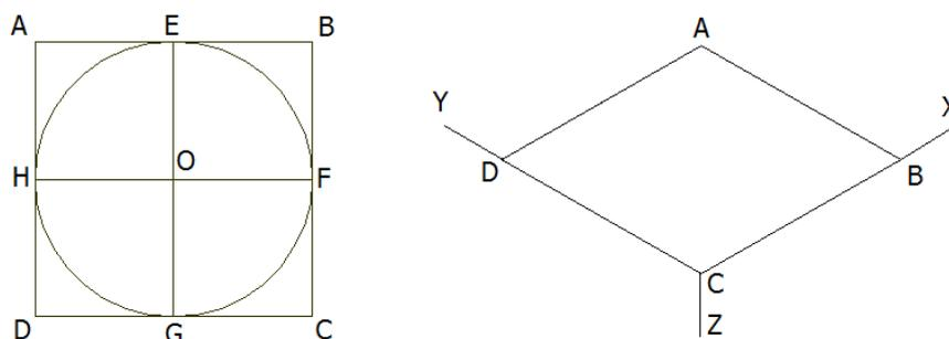
Figura 59 – Etapa 1 da construção da perspectiva isométrica de uma circunferência
