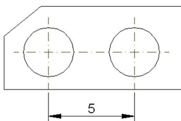
Figura 25 – Linha de centro usada como linha auxiliar
