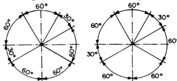
Figura 28 – Cotagem angular no método 1
