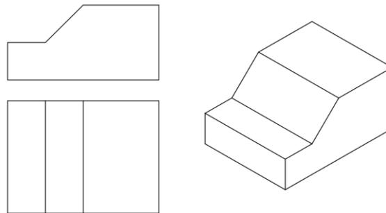
Figura 58 - Linhas isométricas e não isométricas
