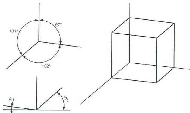
Figura 50 - Perspectiva dimétrica de um cubo
