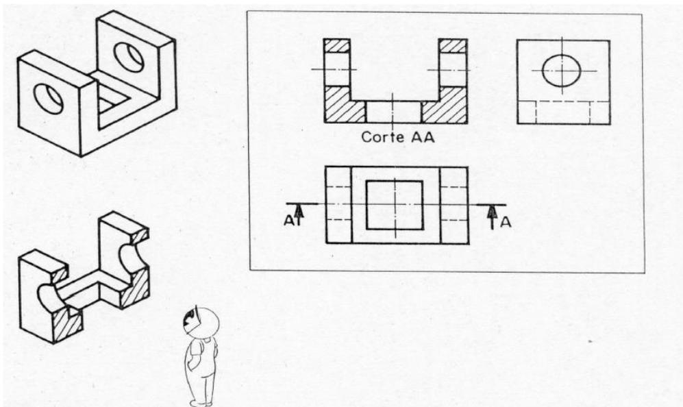
Figura 82 – Corte realizado na vista frontal
