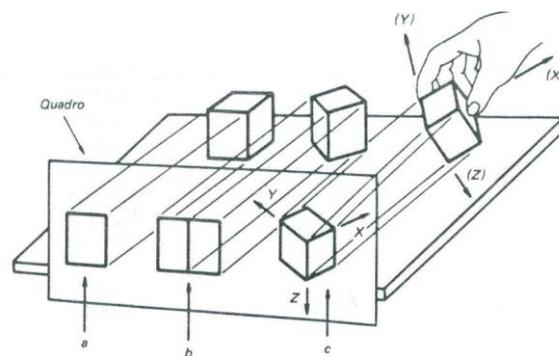
Figura 48 – Perspectiva cilíndrica ortogonal de um cubo
