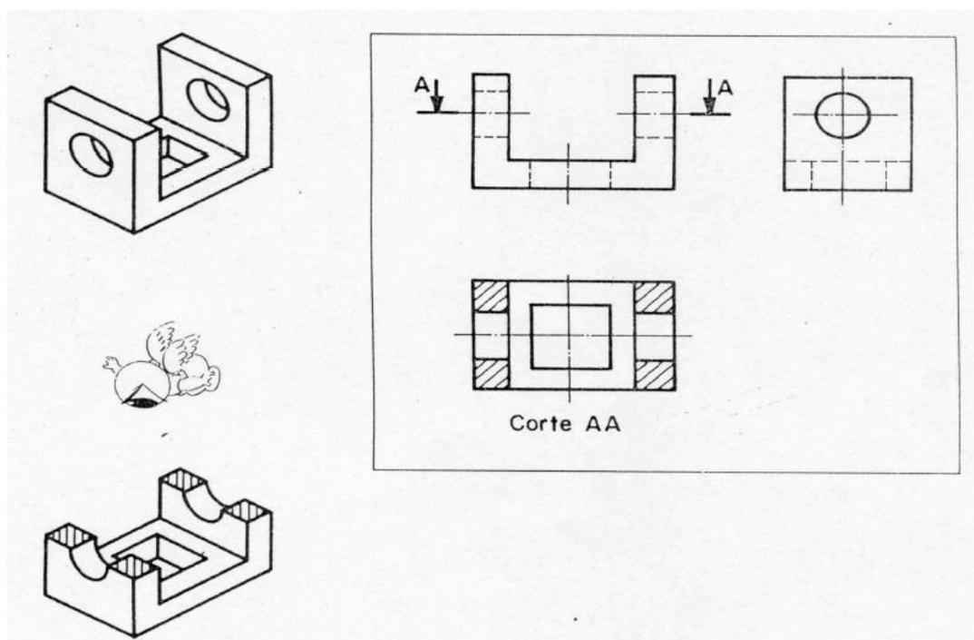
Figura 83 – Corte realizado na vista superior
