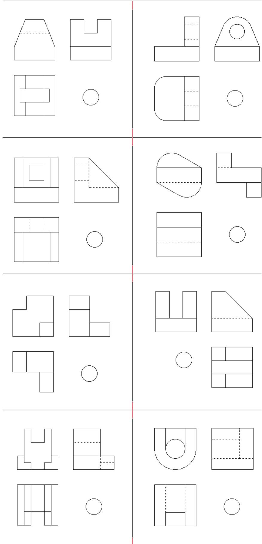
2) Identifique a Vista de Frente, a Vista Superior, a Vista Lateral Esquerda e a Vista Lateral Direita nas projeções dadas.
