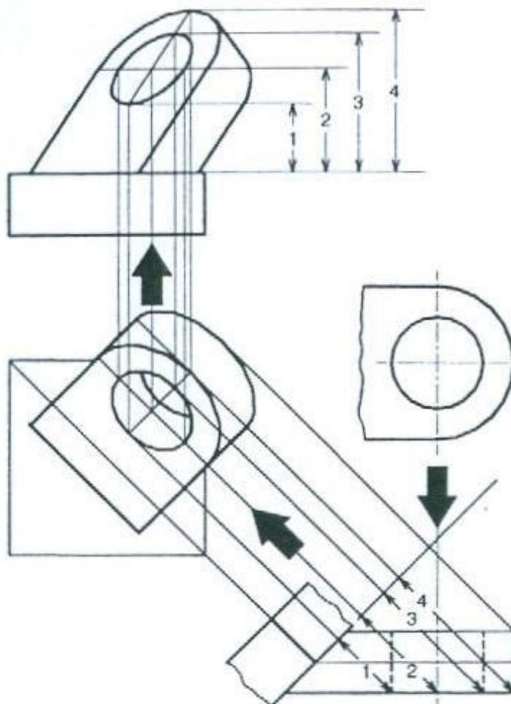
Figura 77 – Peça com dois planos auxiliares de projeção
