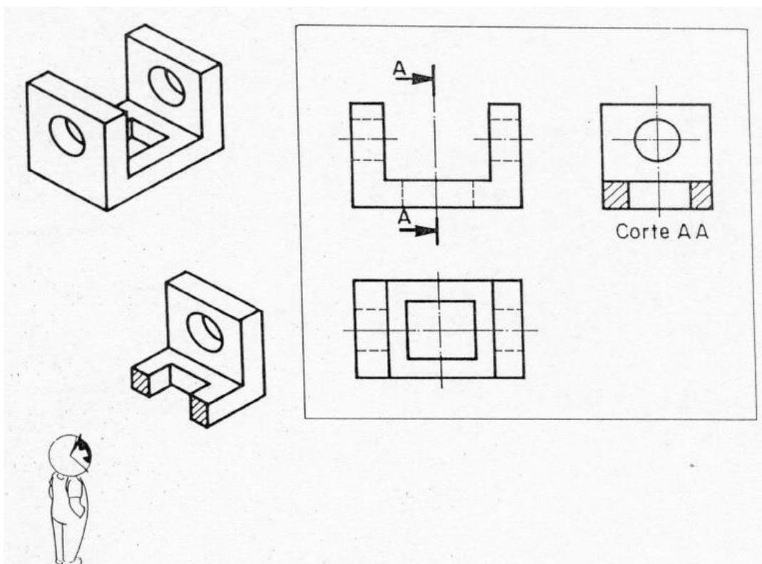
Figura 84 – Corte realizado na vista lateral esquerda
