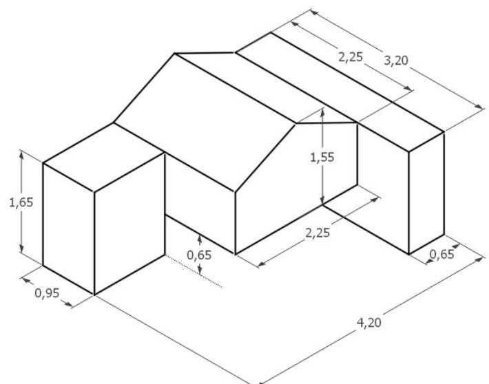
20) Desenhar as três vistas ortográficas dos objetos: VF, VS e VLE.
