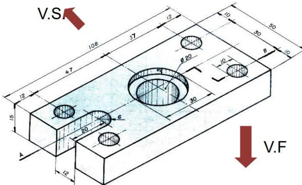
02 - Representar as vistas das peças abaixo e substituir a vista frontal por um Corte Longitudinal. Aplicar a Hachura de acordo com as Normas da ABNT.
